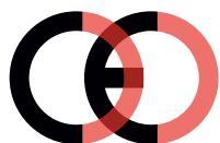
Falsk CE-mærke (for tæt på hinanden)
